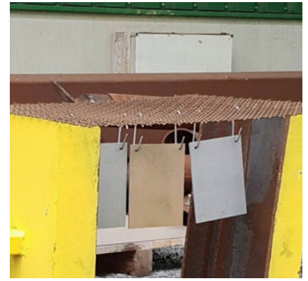
Bewitterungsversuche zeigten, dass Edelstahlgrit temporären Korrosionsschutz bietet.
