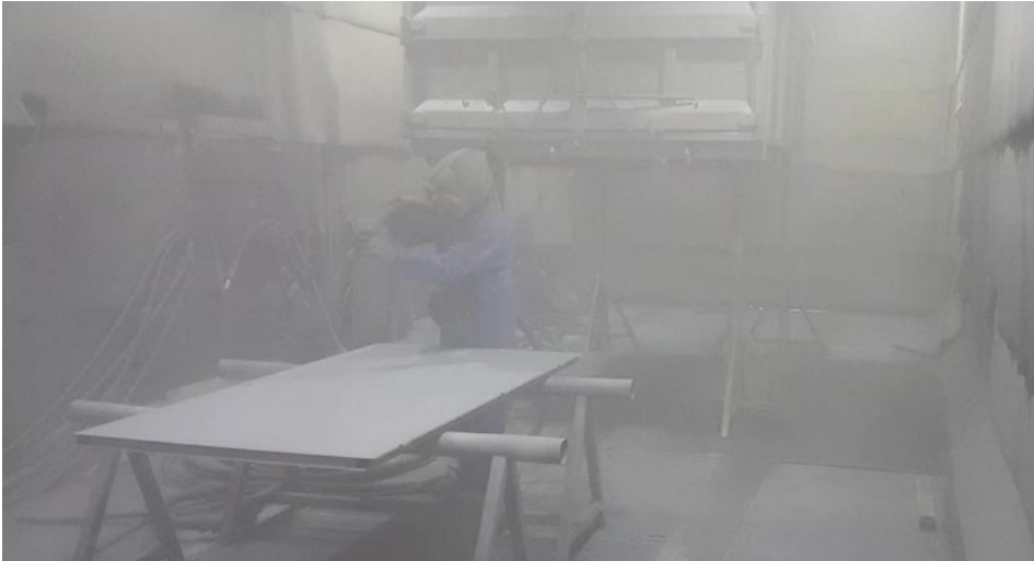
Beim Einsatz von mineralischem Strahlmittel verschwinden Werker und Bauteil im Nebel.
