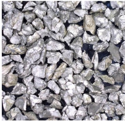
Kantiges Edelstahlgrit ist von der Abtragswirkung her genauso effektiv wie Korund.
