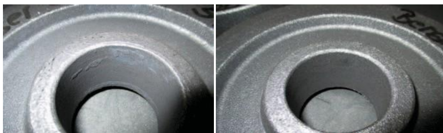
Un componente Cotarko dopo un tempo di sabbiatura di cinque minuti con graniglia a basso contenuto di carbonio (sinistra) e, dopo lo stesso tempo di sabbiatura, con il mix speciale di graniglia Ervin ad alto tenore di carbonio (destra)
