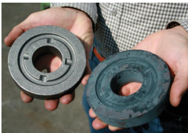
Stato iniziale prima del processo di sabbiatura (destra) e risultato finale dopo il processo di sabbiatura (sinistra)
